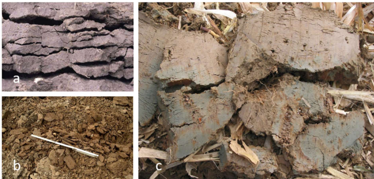
Abbildung 44 Optische Hinweise auf Verdichtungen: a und b. Mauerartige Plattengefüge weisen auf mechanische Verdichtungen hin, etwa nach Befahren mit schwerem Gerät bei wassergesättigtem Boden c. Rost- und Reduktionsflecken sind Indikatoren für temporären Staunässe Einfluss oberhalb von Verdichtungshorizonten, beispielsweise auf Pseudogleyböden. (SCHULTE-KARRING M., 2016)
