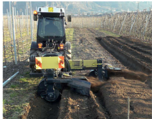
Abbildung 49 Vimas-Baumpflanz- Doppelfräse im Einsatz
