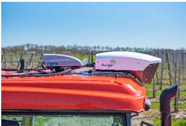
Abbildung 466 TMS TreeScout® der Firma Aurea Imaging mit einem auf dem Schlepperdach installierten Raven GPS – System. Quelle: Aurea Imaging©
