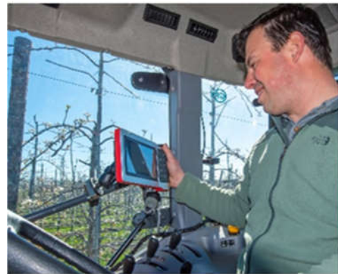
Abbildung 468 Der in der Schlepperkabine installierte Kontrollbildschirm ist mit dem TreeScout verbunden. Auf ihm werden die von der RGB-Kamera erfassten Bildsequenzen wiedergegeben. Quelle: Aurea Imaging©
