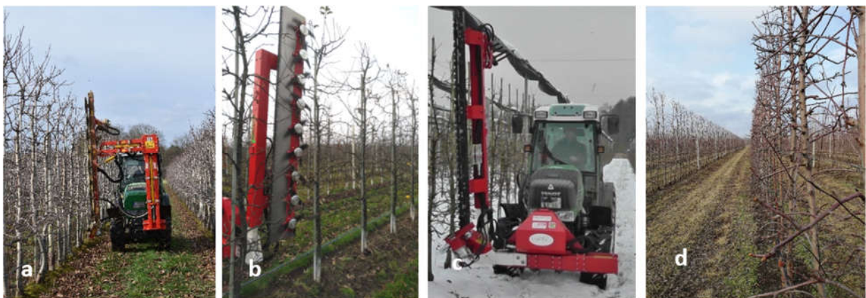
Abbildung 386: Maschineller Schnitt während der Winterruhe ausgeführt mit verschiedenen Schnittwerkzeugen: a. mit Sägeblättern, b. mit rotierenden Messern, c. mit Messerbalken, d. Unmittelbar nach dem Schnitt
