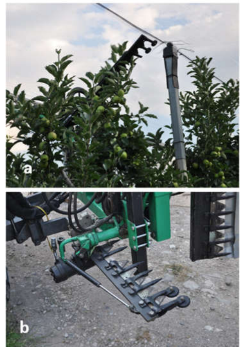
Abbildung 445 a und b: Über- und Unterschnittbalken am Schnittgerät der Firma FAMA
