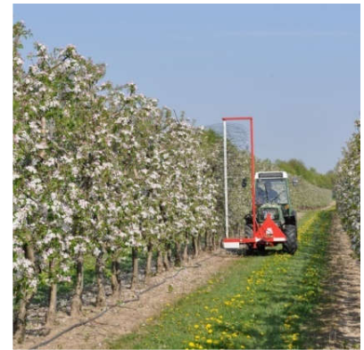
Abbildung 406: Die Darwin-Ausdünnmaschine in einer maschinell geschnittenen Baumreihe im Einsatz
