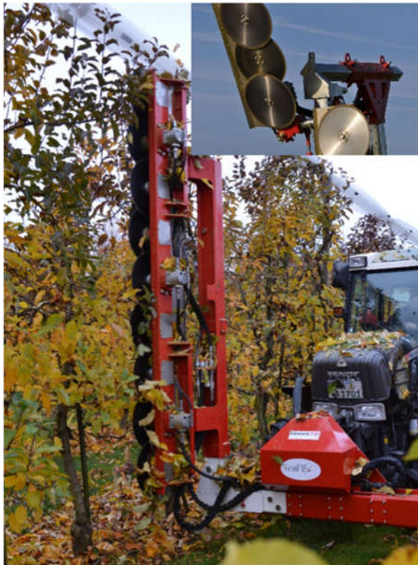
Abbildung 442: Rotierende Sägeblätter werden bei der Umstellung von Altanlagen und der regelmäßigen Rekonstruktion der Reihenarchitektur gebraucht
