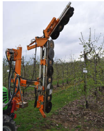
Abbildung 441: Horizontaler Zusatzbalken mit Sägeblättern. Hydraulische Seitenverschiebung und Seitenneigung
