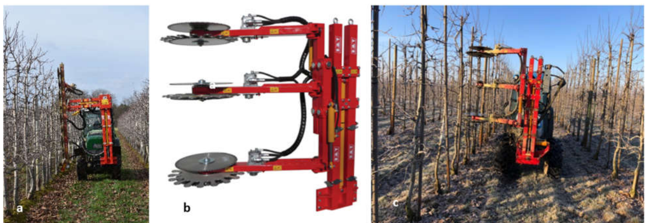
Abbildung 446: Nach dem Einsatz des vertikalen Schnittgerätes (a) kann der Einsatz des BMV-Fensterschnittgerätes mit drei horizontal installierten rotierenden Messern erfolgen (b, c)
