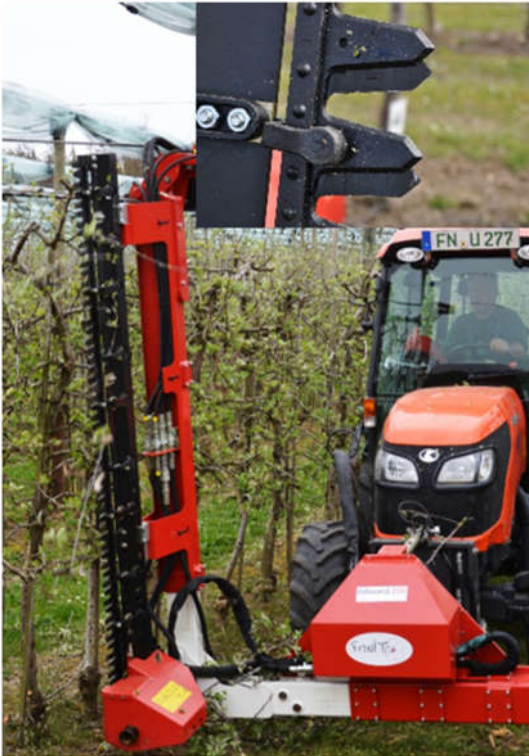
Abbildung 444: Gegenläufige Messerbalken von Fa. Fruit Tec und aufgenieteten Messern. Geeignet für den jährlichen Konturenschnitt, wenn es um dünnes Holz geht, und für den Vorernteschnitt. Die Geräte sind verhältnismäßig preisgünstig und leicht.
