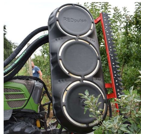
Abbildung 394 Kombinationsgerät: Pneumatische Entlaubung mit vorgeschaltetem Messerbalken von Fruit Tec
