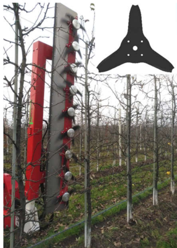
Abbildung 443: Rotierende Schlagmesser sind mittlerweile zum Universalgerät beim maschinellen Schnitt geworden. Sie arbeiten mit hoher Geschwindigkeit und können ganzjährig benutzt werden, da sie sowohl bei verholzten wie auch und krautigen Trieben gleich gut arbeiten.
