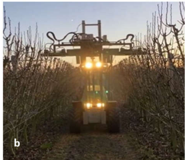
Abbildung 436 a und b: Maschinelle Höhenbegrenzung in einem V-System bei 'Conference' auf circa 2,50 m a. im August sofort nach der Ernte b. im Januar vor dem Handschnitt Bild T. Groot/NL
