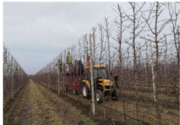
Abbildung 414 Erster Schritt: Schnitt der Baumspitzen mit der Arbeitsbühne und pneumatischen Scheren
