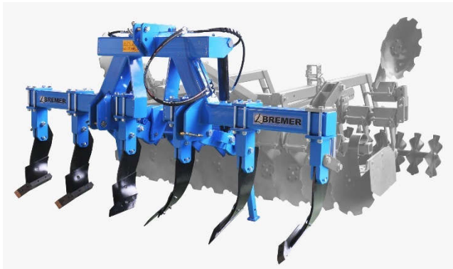
Abbildung 297 Der Tiefenlockerer Parall lockert den Boden bis zu 60 cm Tiefe. Durch die Bogenstellung der Zinken wird der Boden leicht angehoben, durchlüftet, aber nicht gedreht. Der Anbau einer zapfwellengetriebenen Scheibenegge ist möglich (Bild BREMER Maschinenbau)
