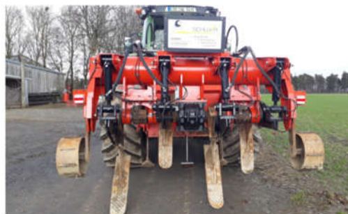
Abbildung 300 Arbeitsweise der Abbruch-Tiefenlockerer nach Schulte-Karring (SchuKa) mit Arbeitstiefen von 50 cm (=MM 50) zur Reihenlockerung bzw. 80 cm (= MM100; siehe Bild rechts) zur Flächenlockerung. Der Einsatz des MM 100 setzt ein ausreichend tief eingegrabenes Drainagesystem voraus
