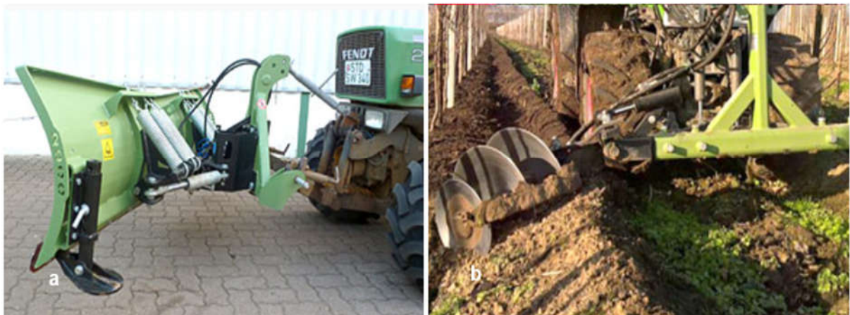
Abbildung 306 a. Planierschild und b. hydraulisch angetriebene Schnecke zur Erstellung von Hügeln (Fotos PWH Landtechnik)
