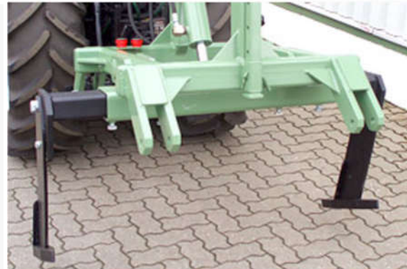
Abbildung 298 Dieser Tiefenlockerer kann bis 50 cm Tiefe verdichtete Fahrspuren anheben und sie wieder auflockern, was der Staunässebildung entgegenwirkt und die Befahrbarkeit wiederherstellt (Bild PWH Landtechnik)
